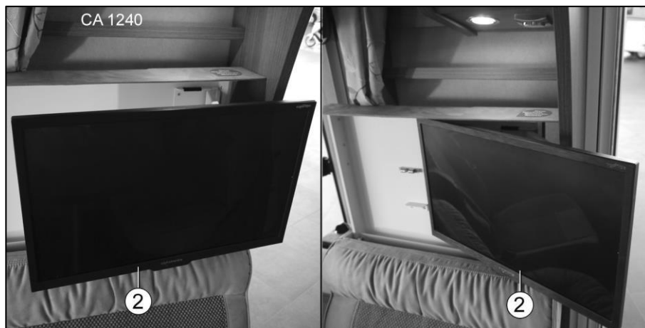
Slika 131 Izvlečni TV nosilec TFT na stranski sedežni klopi
