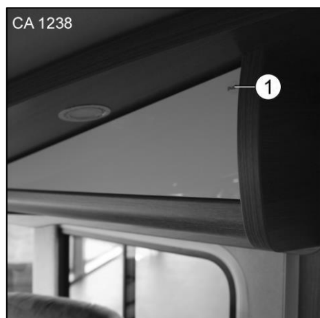
Slika 99 Odpiranje/zapiranje na potisk
