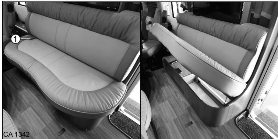
Slika 65 Dvižni mehanizem dolge stranske sedežne klopi
