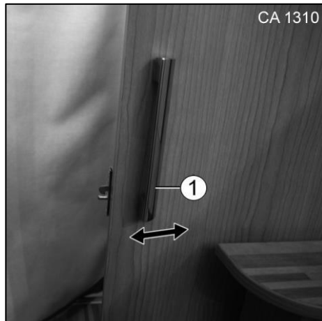
Slika 100 Odpiranje/zapiranje drsnih vrat
