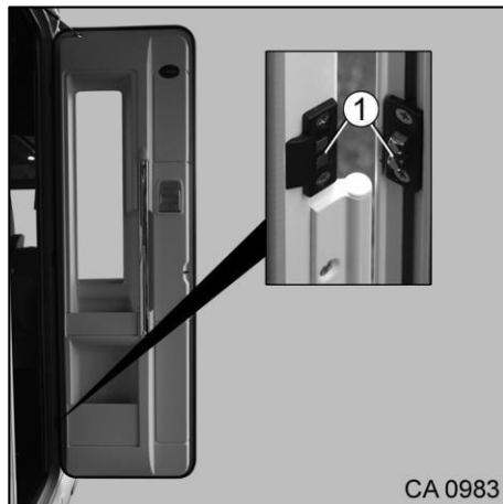
Slika 37 Kontakti za centralno zaklepanje
