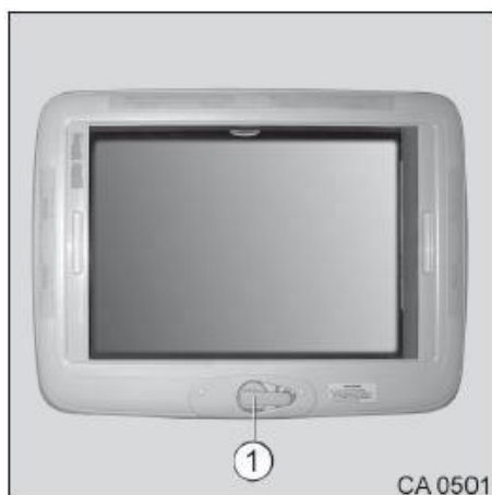
Slika 53 Strešno okno z ročico za ročno odpiranje okna
