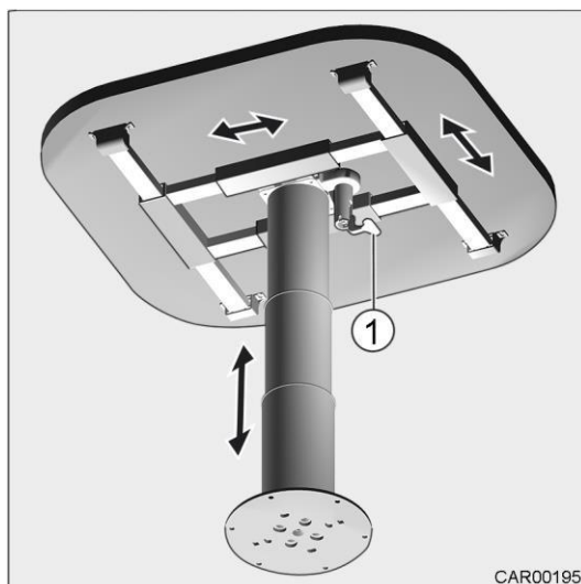
Slika 60 Spuščanje (brez ročice) in premikanje (z ročico) mize
