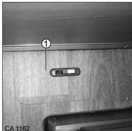
Slika 106 Položaj zapornega ventila za toplotni izmenjevalnik, Iveco
