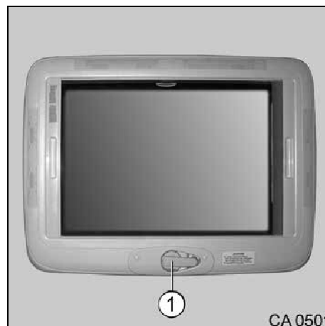
Slika 54 Strešno okno z ročico za ročno odpiranje okna
