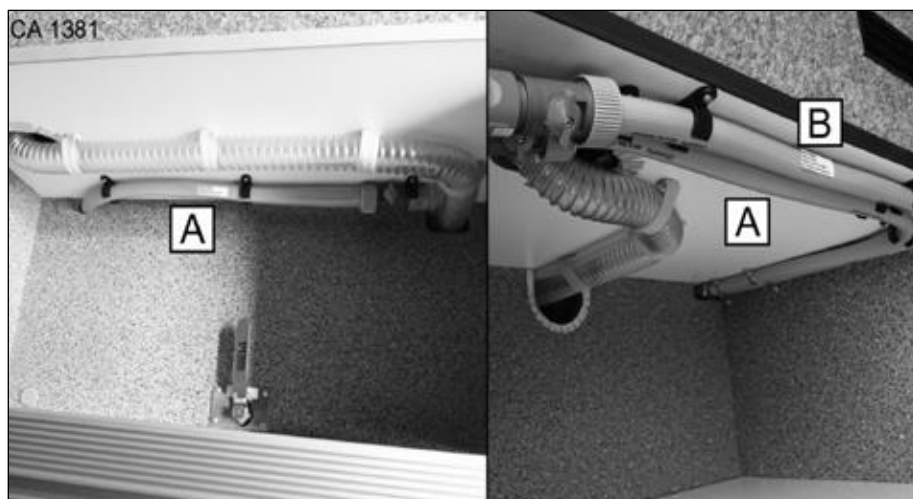
Slika 136 Cev za izpiranje pri modelu Fiat/ cev za izpiranje pri modelu Iveco
