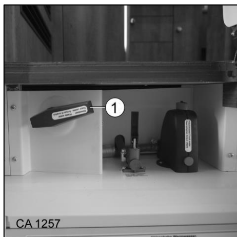
Slika 131 Praznjenje rezervoarja za odpadno vodo
