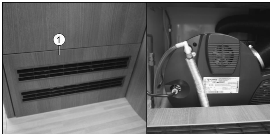
Slika 104 Grelnik pod garderobno omarico
